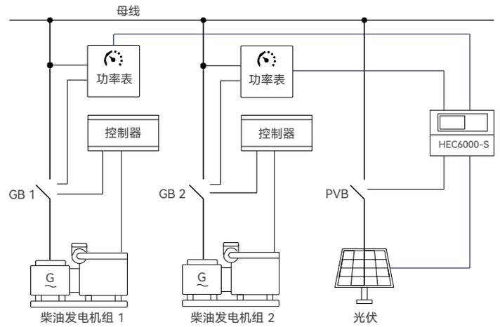
发电机组控制器的功率变送输出
